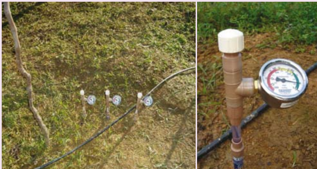
Figura 2 - Tensiômetros instalados no parreiral para o monitoramento da umidade do solo
