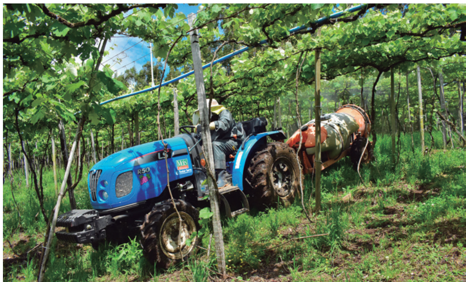
Dimensões do veículo permitem o uso em parreirais, o que demanda altura e largura bastante específicas para as operações
