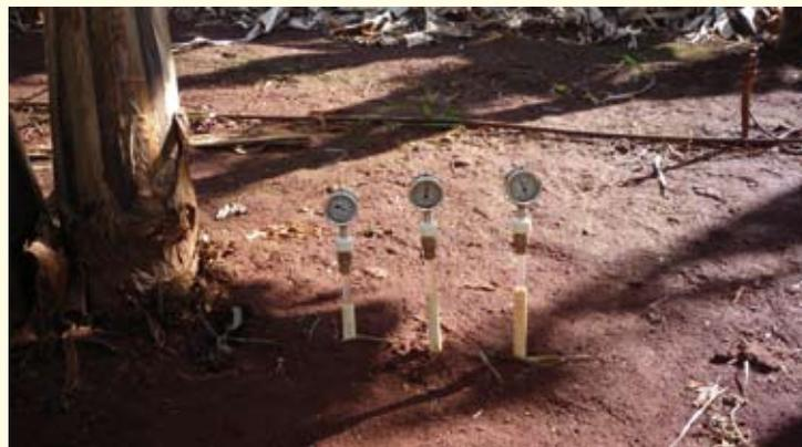
Monitoramento de irrigação com a utilização de tensiômetros (20cm, 40cm e 60cm de profundidade)
