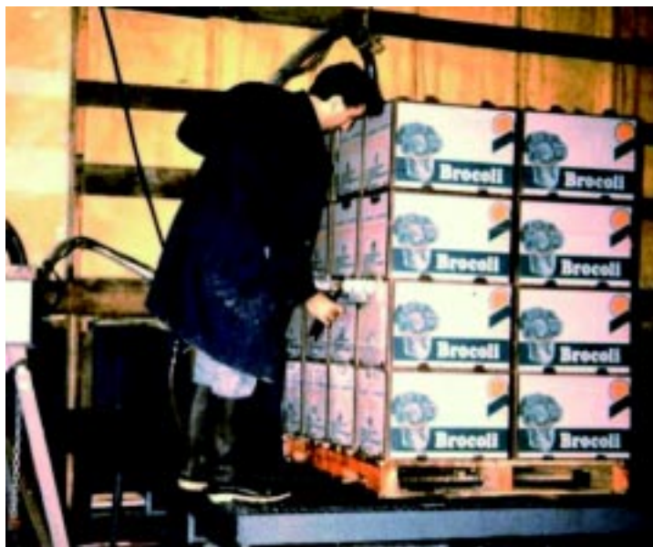
Resfriamento de brócolis com injeção de mistura de gelo e água diretamente nas caixas
