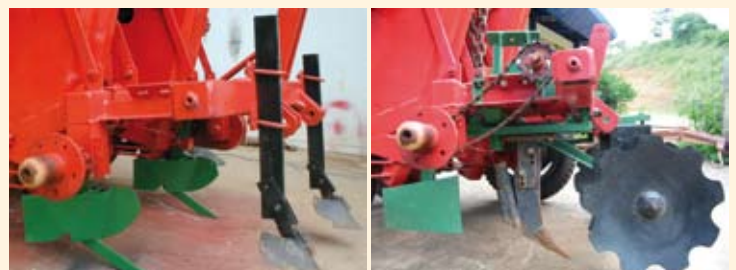
Figura 1 e 2— Mecanismo adaptado à plantadora, mostrando sulcador frontal e separador do adubo com haste escarificadora (esq.), e conjunto de discos de grade, sulcador tipo bota e separador de adubo (dir.)
