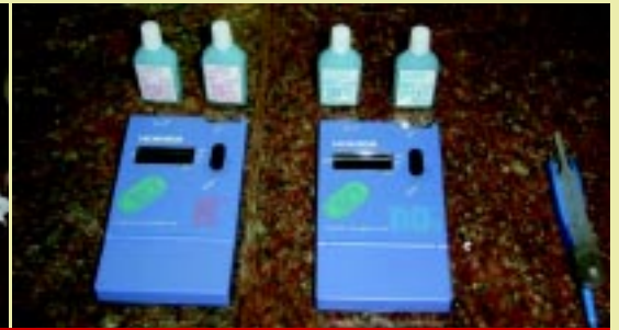
Conduvímeter usado na leitura da condutividade elétrica da solução extraída do substrato (CEes) e os testes rápidos (kits horibas) utilizados na fertirrigação
