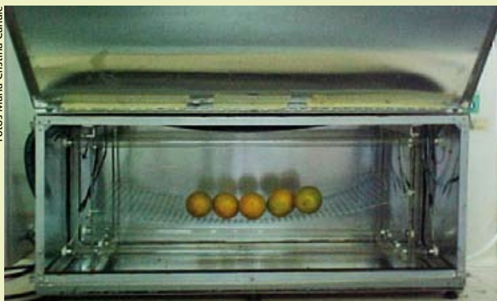
Câmara para exposição de produtos vegetais à luz UV-C do GEPC/Ital
