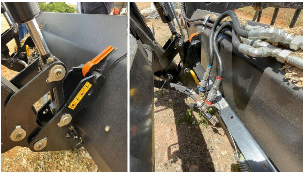
Detalhe do engate rápido (esquerda) e das conexões do terceiro comando (direita)
