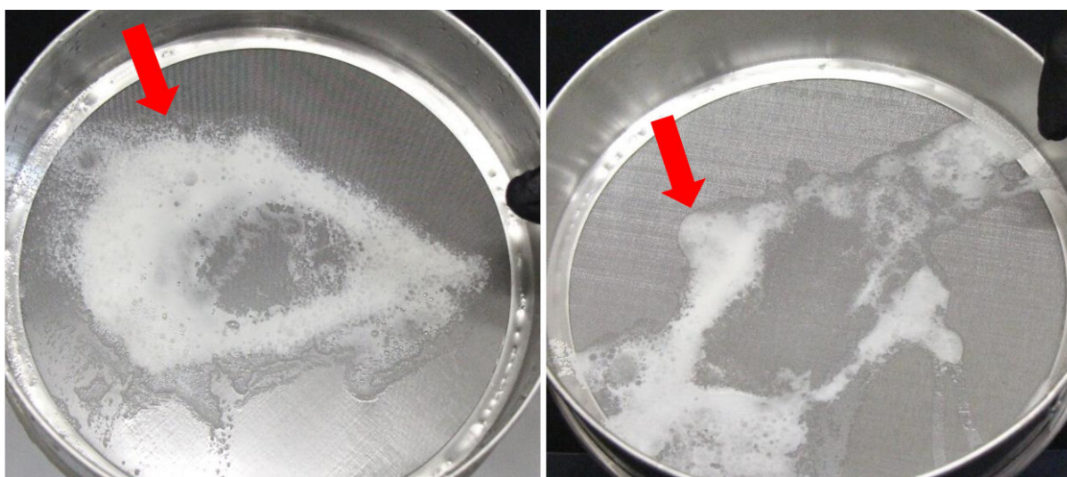
Exemplo de problema de compatibilidade das misturas com gli wg1 + 2,4-D nas taxas de aplicação de 40 L/ha (a) e a 80 L/ha (b) com resíduos, similares a espuma, nas peneiras de 100 mesh
