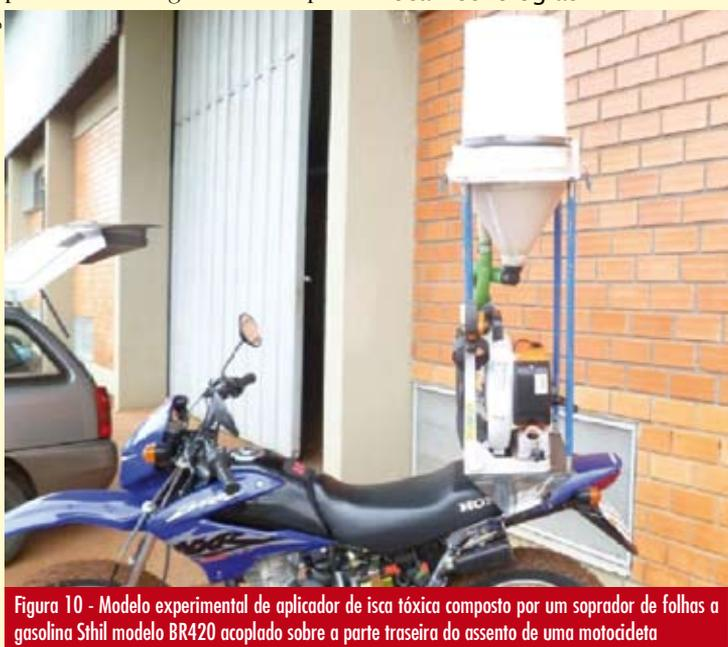
Figura 10 - Modelo experimental de aplicador de isca tóxica composto por um soprador de folhas a gasolina Stihl modelo BR420 acoplado sobre a parte traseira do assento de uma motoçideta
