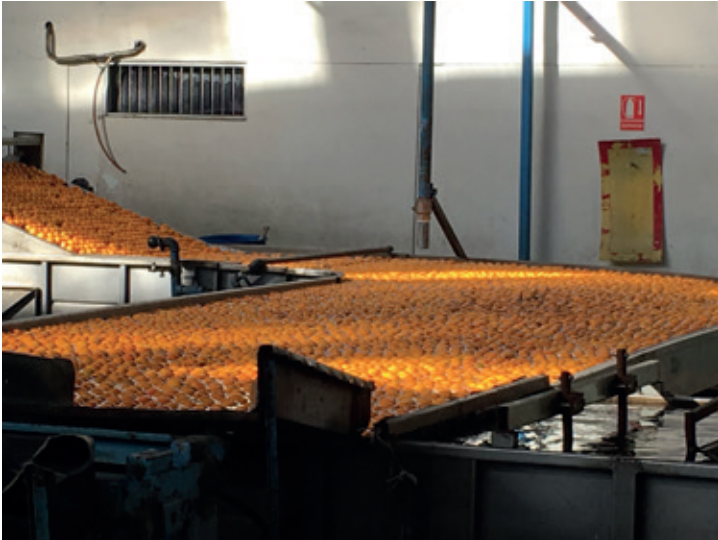
Frutos de laranja em balsa de imersão com bactericida para descontaminação contra a bactéria causadora do cancro cítrico
