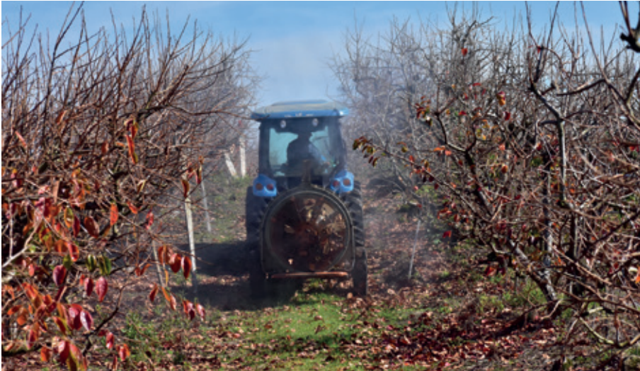
A cabine pressurizada garante conforto ao operador e aplicação de defensivos sem risco de contaminação
