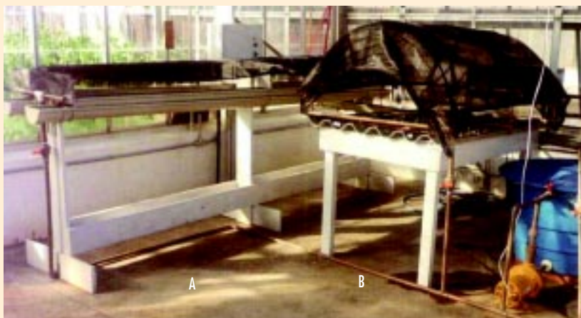
Sistemas hidropônicos testados na produção de material pré-básico: calhas de PVC articuladas (A) e telhas de fibrocimento (B)
