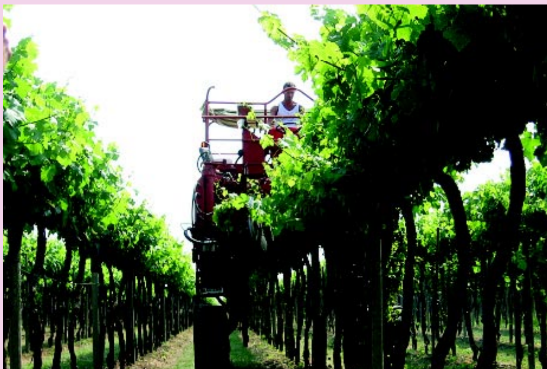
Desfolha e desposte realizados com o equipamento Trinova em parreiral
