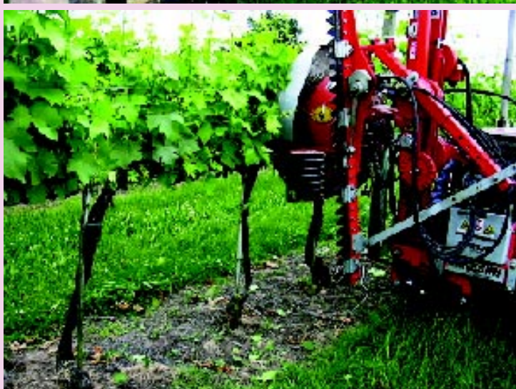
Desfolha mecânica na cultivar Sangiovese realizada pelo implemento Pluker®
