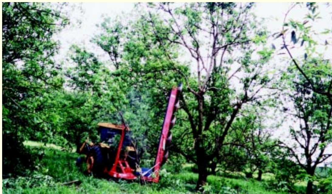
Figura 4 - Sistema de poda do abacateiro, utilizando uma podadeira acoplada a um trator, utilizado pela Empresa Cafétotal
