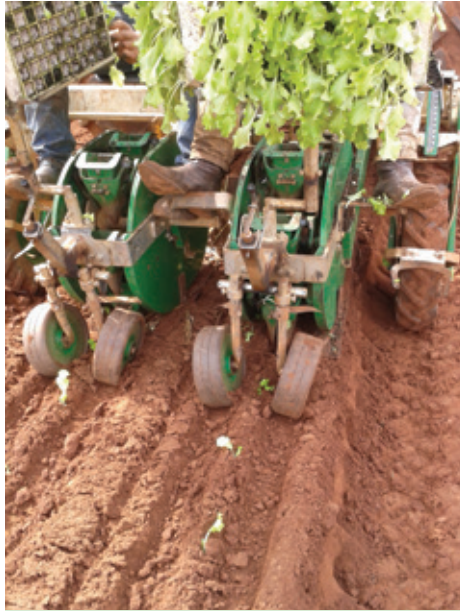
Transplante mecanizado da alface em preparo convencional
