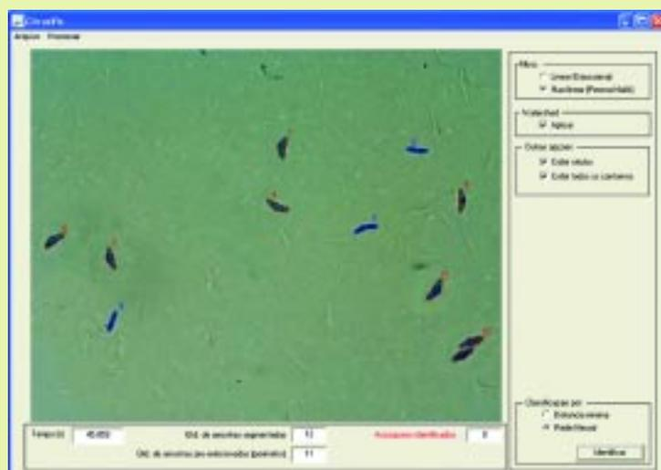
Interface do sistema CitrusVis - um sistema de visão artificial que auxilia na verificação e contagem de esporos
