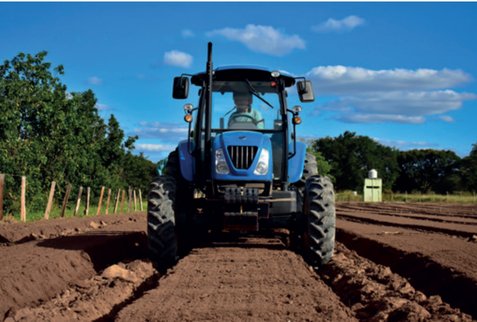
Plus 90 utilizando enxada rotativa com encanteirador
