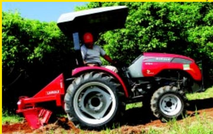
O Agrale 41184 tem motor M95W vertical de 18cv e 744 cilindradas
