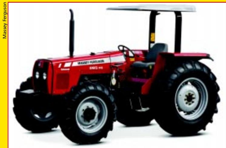
O MF 265 XE tem motor MWM Internacional de 65cv, de aspiração natural e tração nas quatro rodas
