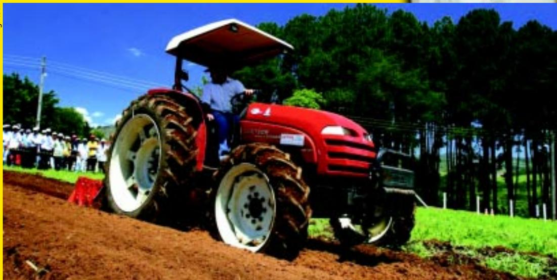
O Yanmar 1155-4 tem tração 4x4, motor de 55cv diesel, TDF de 45,6cv a 540rpm, transmissão de oito velocidades à frente e duas à ré
