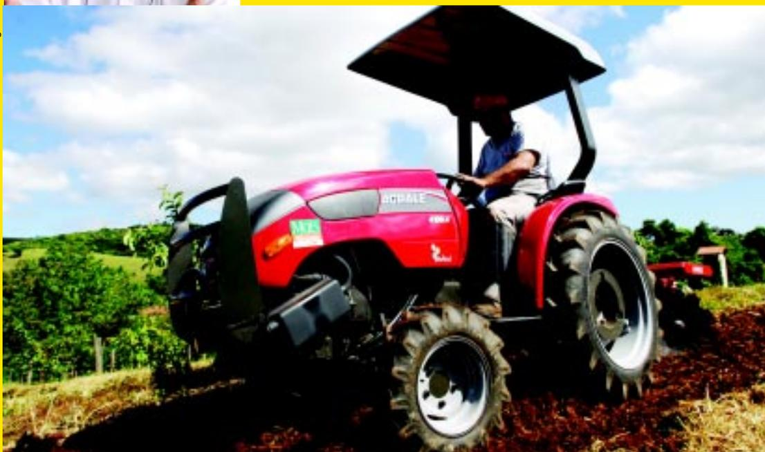
O modelo 4100 da Agrale vem equipado com motor M93, de 15cv, 668cc e tem versão 4x4
