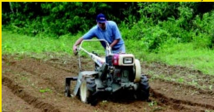
O motocultivador (microtrator) modelo TC12 da Yanmar possui motor de 11cv diesel refrigerado a água
