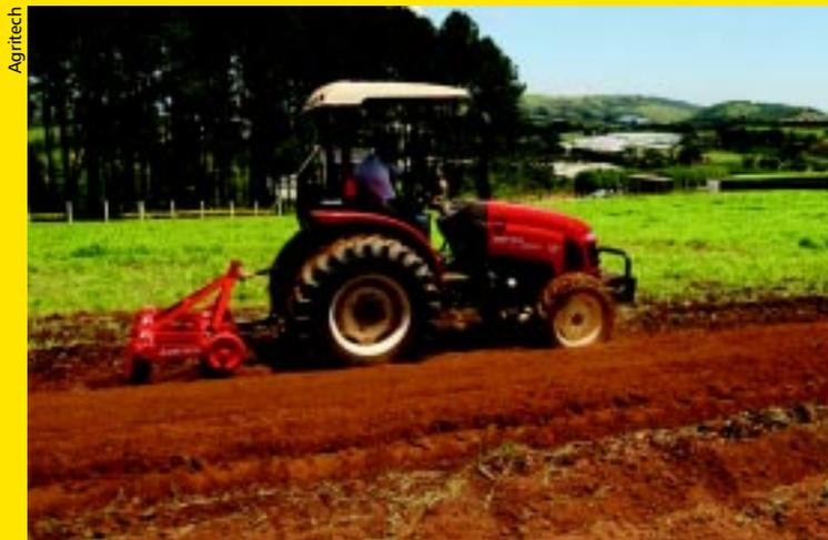
O Yanmar 1175-4, com tração 4x4, motor de 75cv, TDF de 59cv a 540rpm
