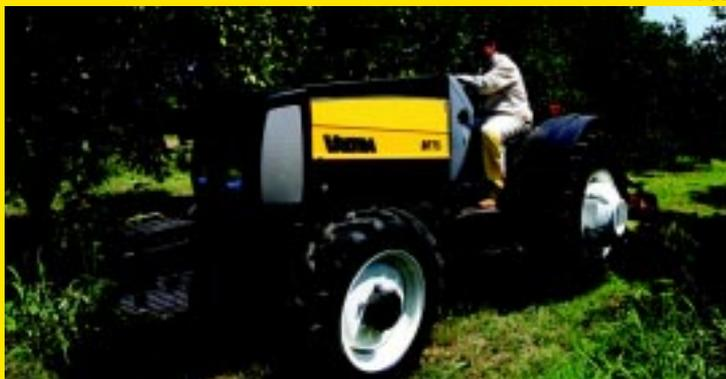
O Valtra BF 75 Fruteiro vem equipado com motor Sisu Diesel 320DSR de três cilindros de 72cv
