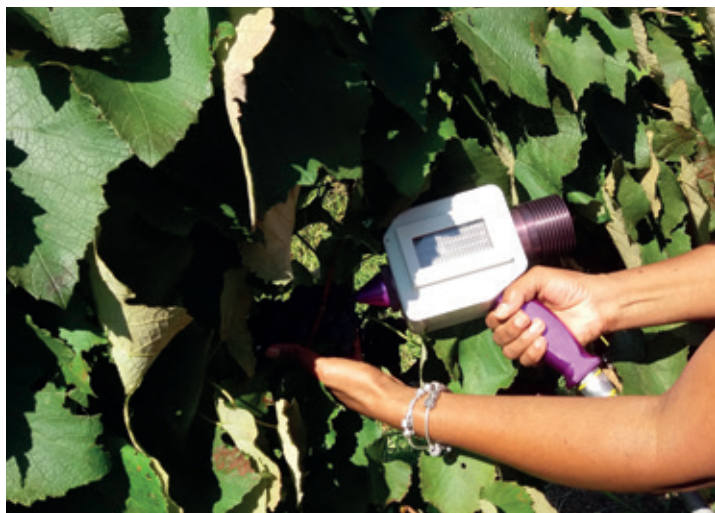
Demonstração de tomada de espectros a campo com o NIRs portátil Luminar 5030
